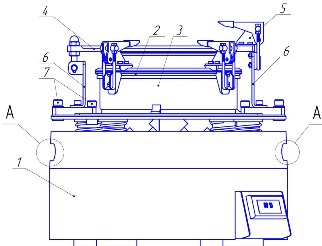
1 - Вибропривод ВП 30Т; 2 - Сито; 3 - Поддон; 4 - Траверса; 5 - Латчер; 6 - Кронштейн; 7 - Винт; "А" - отверстие.
