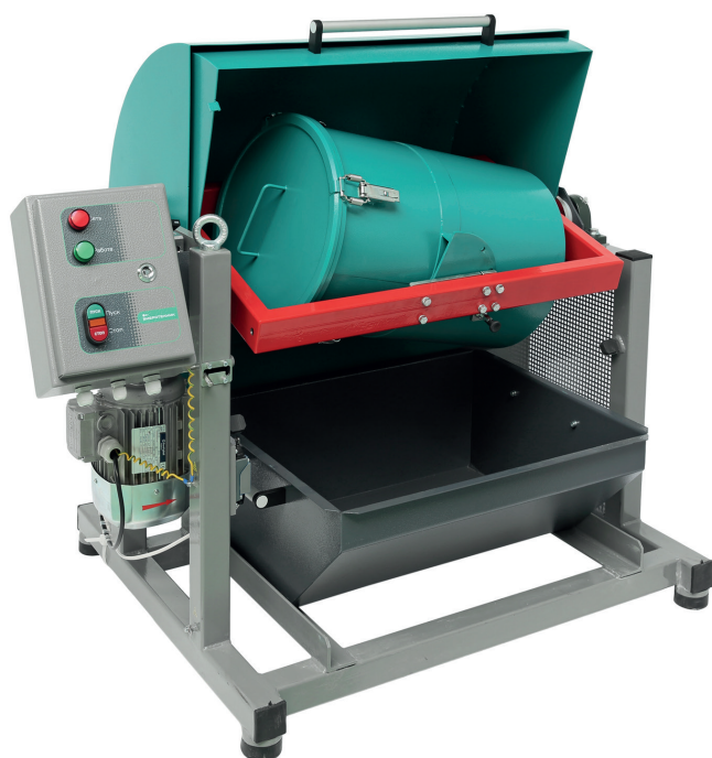
Смеситель С 50.0 «Пьяная бочка» в рабочем положении, угол наклона бочки - 15%
