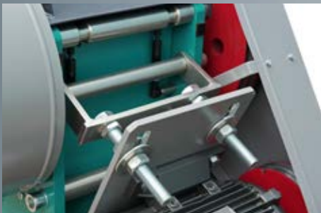
Устройство регулировки натяжения ремней электродвигателя дробилки ЩД 15
