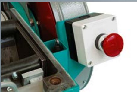
Аварийная стоп-кнопка, концевой микровыключатель и отверстие крепления рым-болта
