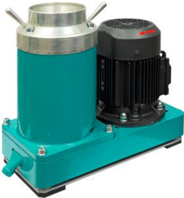
Рис. 1 Вибрационная конусная мельница-дробилка ВКМД 10 Рис. 2 Анализатор А 20
