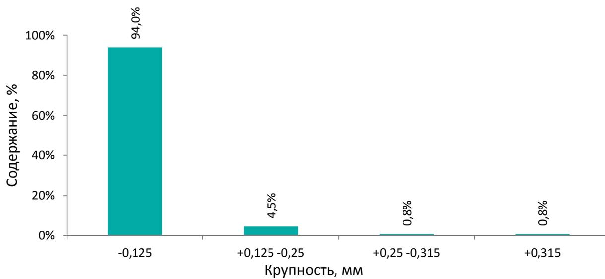
Рис. 5. Гранулометрического состав продукта измельчения
