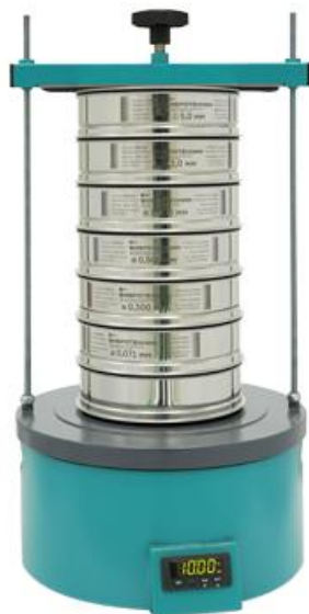
Рис. 1. Анализатор А 20 на базе Вибропривода ВП 30Т
