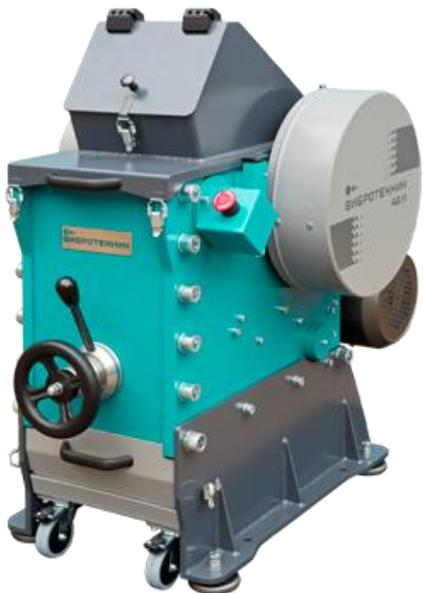
Рис. 1. Щековая дробилка ЩД 15
