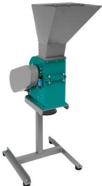
Рис 1. Молотковая дробилка МД 2х2
