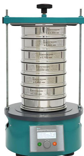
Рис. 2. Анализатор А 20 на базе Вибропривода ВПС
