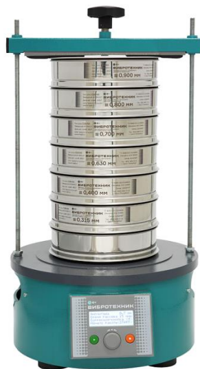
Рис. 2 Анализатор А 20 на базе Вибропривода ВПС
